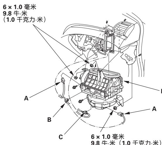
4. 按照与拆卸相反的顺序安装单元。确保没有空气泄漏。
