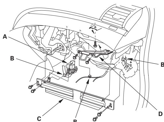
3. 将连接器 (A) 从鼓风机电枢和内循环控制电机上断开，然后拆下线束夹 (B) 和连接器卡扣 (C)。拆下安装螺母、安装螺栓和鼓风机单元 (D)。
