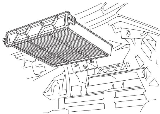
3. 将滤清器 (A) 从壳体 (B) 上拆下，并更换滤清器。
