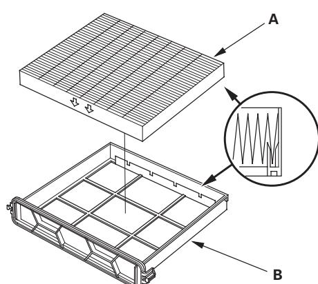
4. 按照与拆卸相反的顺序安装滤清器。确保蒸发器不漏气。
